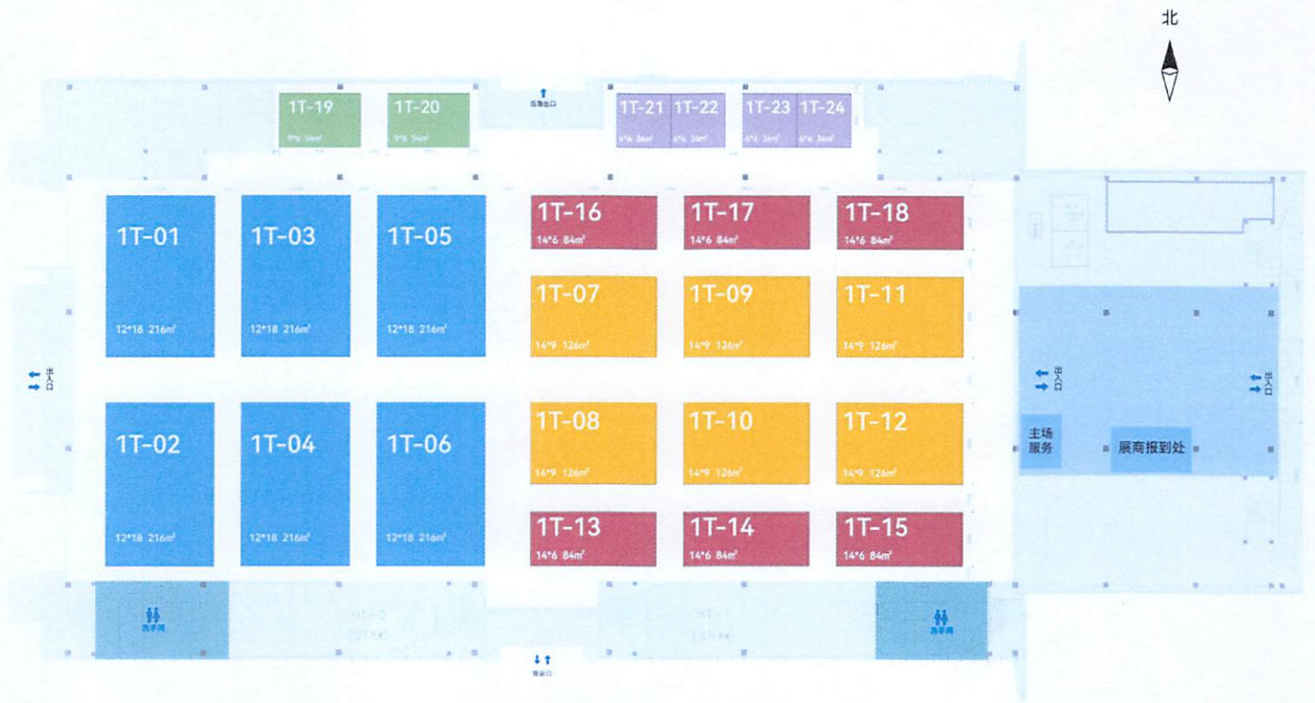
1号展厅 面积:5600m 2 净高:21m 1T01~1T18展位限高5m,1T19~1T24展位限高4m
